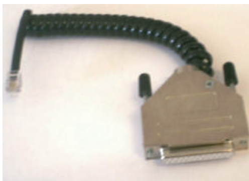
Programmieradapter für RS232 Anschluß am PC / Laptop. Artikelnummer 01018-01
