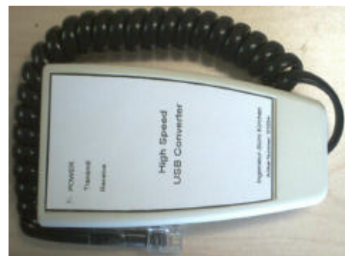
Programmieradapter für USB Anschluß am PC / Laptop. Artikelnummer 01034-01
